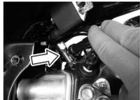
3. 断开束带③与燃油箱盖④的连接。
