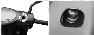
注意检查前面的制动液缸内的液面位置。如果液面过低则添加指定的制动液。因为制动片磨损时，制动液缸内的制动液会自动注入制动液软管而液面随之降低。补充制动液是定期维护保养的重要项目。
