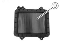
4. 拆下螺钉⑧，拆下纸滤芯⑨，检查纸滤芯⑨，纸滤芯不用清理，检查、更换纸滤芯即可。
