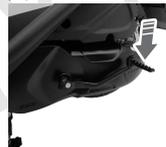
本摩托车装有脚起动杆，位于发动机的左边。要起动发动机时，需用主停车架平稳地支起摩托车后，再用力踩下脚起动杆。
