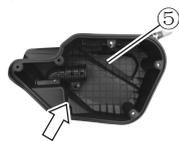
5. 清理空气滤清器壳体 and 空气滤清器盖⑤内的灰尘。
