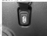
在前货箱上面，配有一个电源接口。打开防护胶盖可以看到。发动机运转时，电源接口可以提供最大为18瓦(18W)的电源输出。使用电器附件前，检查额定功率是否符合要求。
