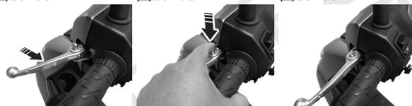
使用后制动锁定装置可以防止摩托车在停车或者怠速时移动。使用后制动锁定装置时，先握紧后制动手柄，然后按下按钮，接着释放后制动手柄，待按钮锁定不自行弹起，表示后制动器已经锁定。
